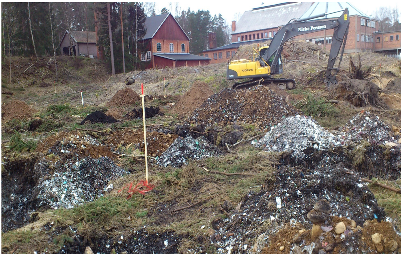
Provtagning i utsatta och inmätta SEV:ar på deponin
